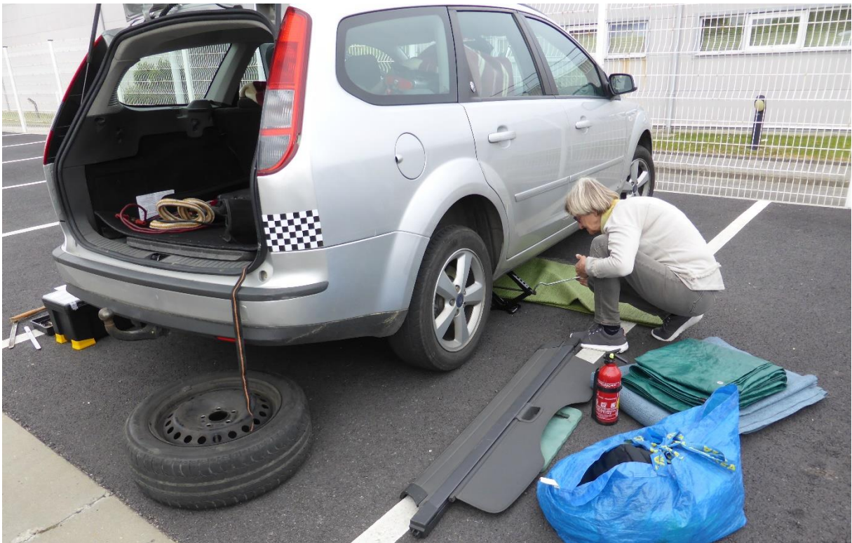
Die Krönung des heutigen Tages, Tank musste wieder befestigt werden.
